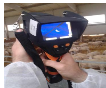
Foto 6P.- Control de la temperatura de la nave mediante termografía.
